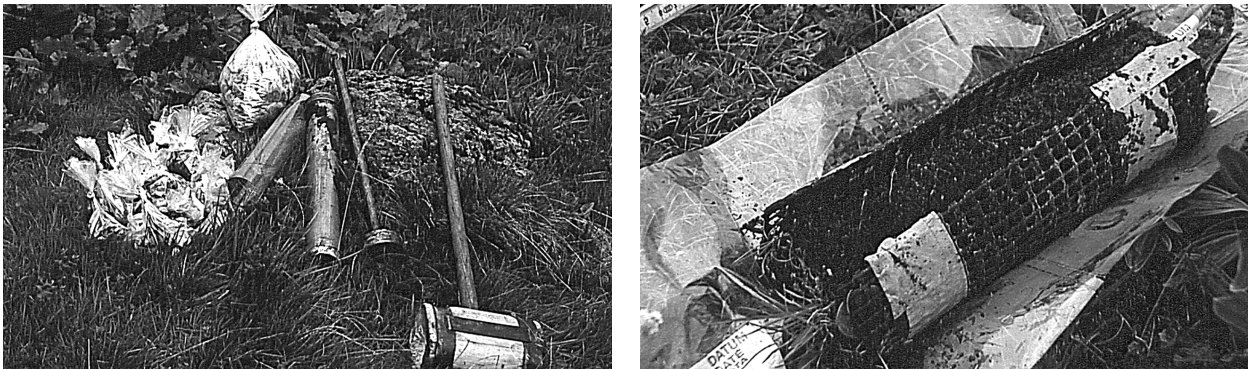
Abb. 4.3: Bild der verwendeten Entnahmewerkzeuge (Bohrrohr mit Aufsatz, Plastikhüllen und Hammer) und Beispiel einer Säule nach der zweijährigen Verpflanzung an Ort (rechts).
