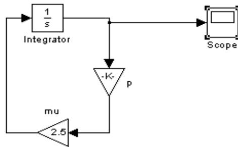
Abb.6: Graphisch orientierte Simulink-Darstellung einer Differentialgleichung
